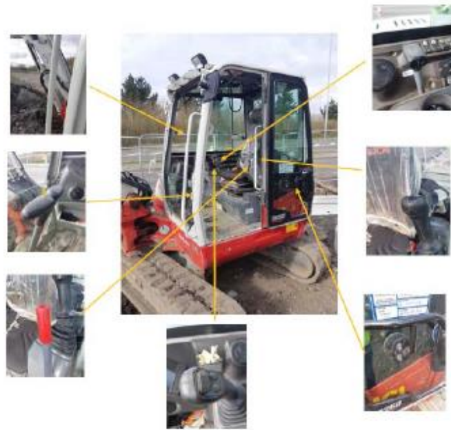
Contact Points in a Mini Digger
